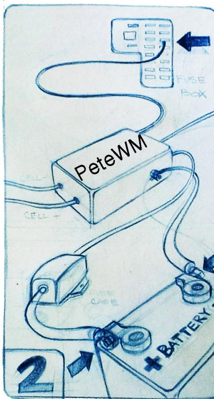
CONNECT THE  $\ominus$  GROUND & THE  $\oplus$  POWER WIRE FROM THE PWM TO THE BATTERY.
