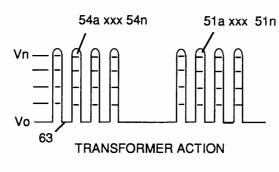
FIGURE 3-19: SETUP VOLTAGE PULSE TRAIN
